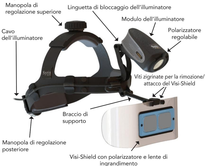
Figura 1: Sistema v900L, illuminatore e Visi-Shield
